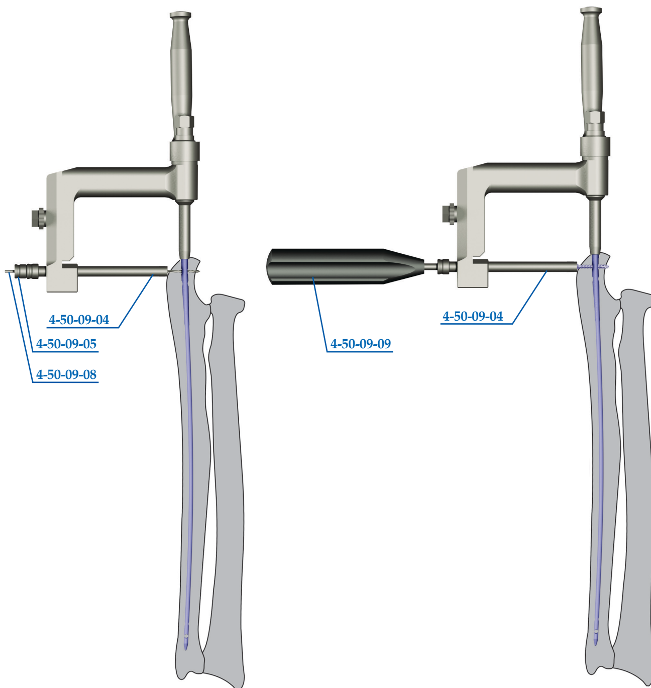
Rys. 4. Ryglowania gwoździ w części bliższej - wiercenie otworu i wprowadzenie wkrętu korowego
